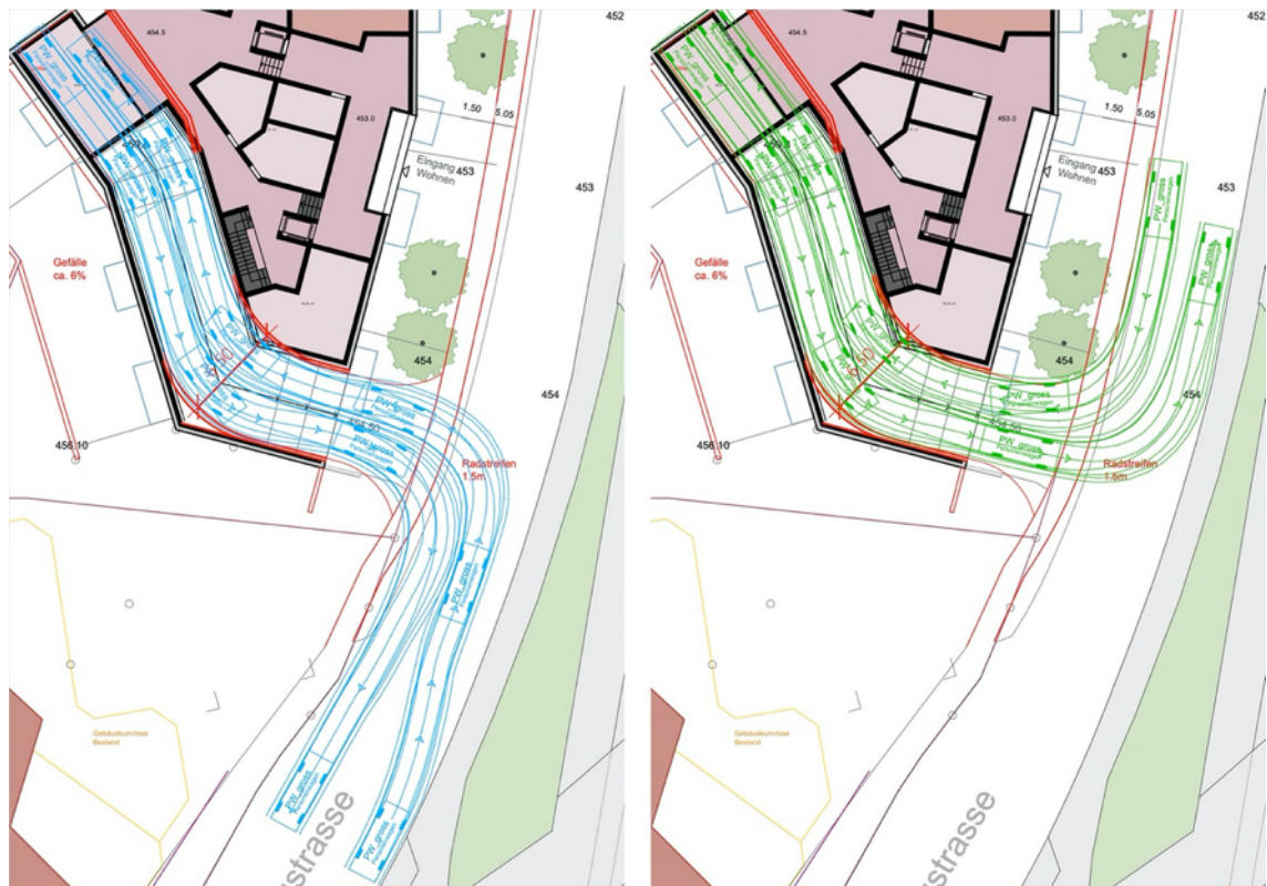
Abbildung 2: Schleppkurven Rampe Variante 2
