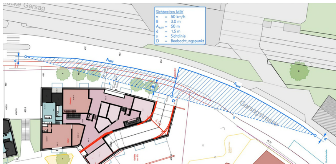
Abbildung 3: Sichtweiten der Ausfahrt Variante 2 für den MIV
