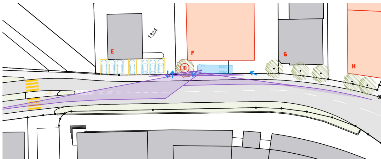
Abb. 5: Anlieferung vor Baubereich F mit Lastwagen
