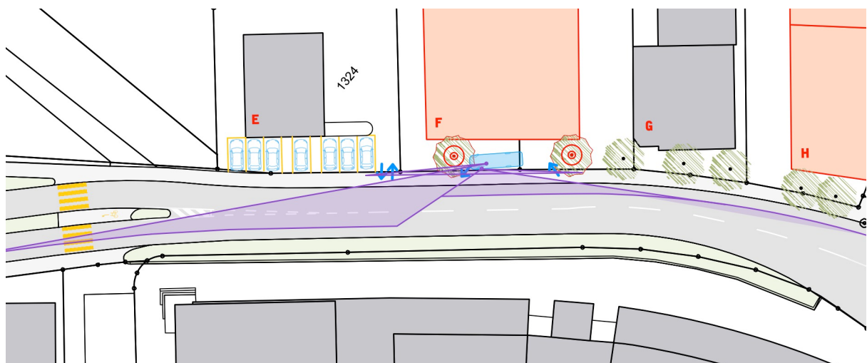
Abb. 6: Anlieferung vor Baubereich F mit Transporter
