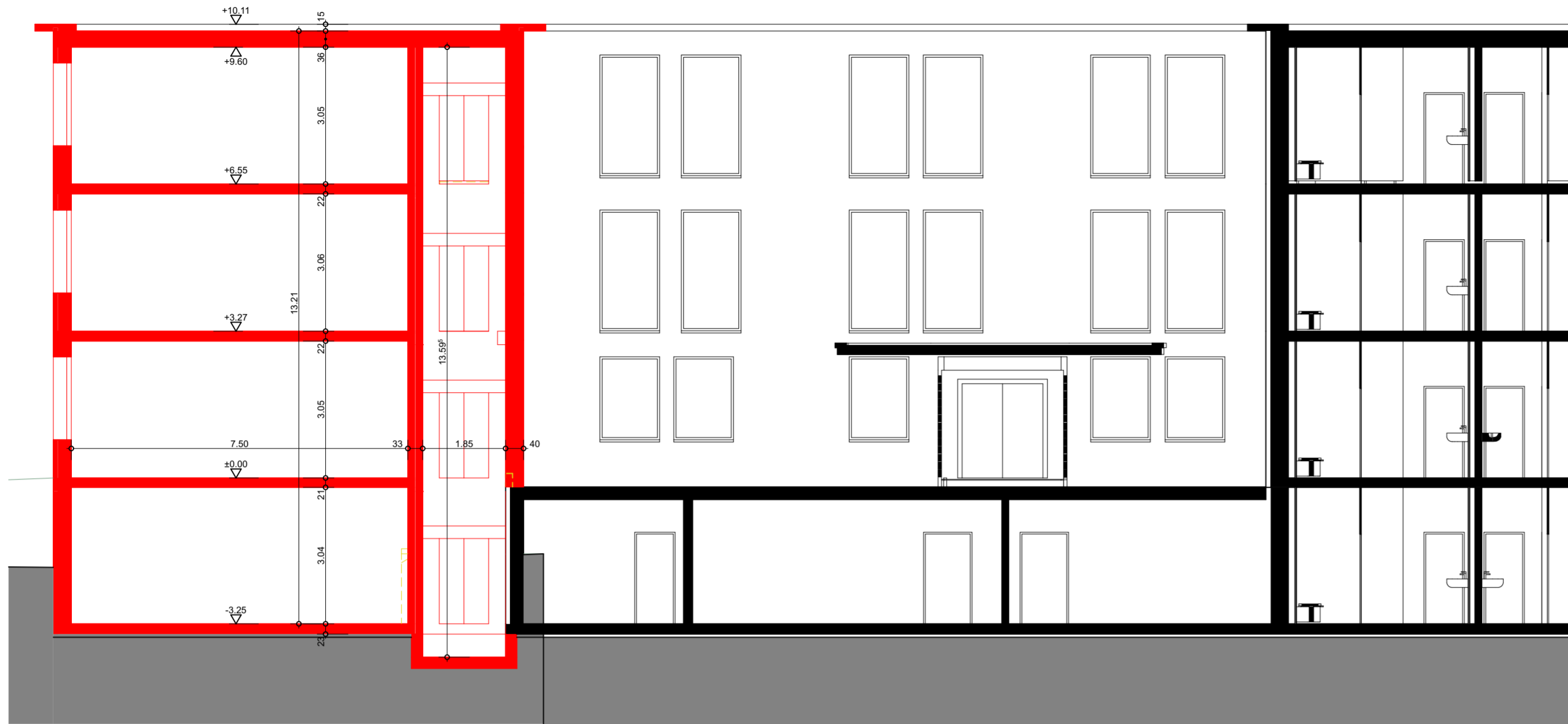
Längsschnitt Schultrakt mit Anbau 1:100
